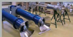
Pumper til renselanlæg, 2 til 5 % faststof
